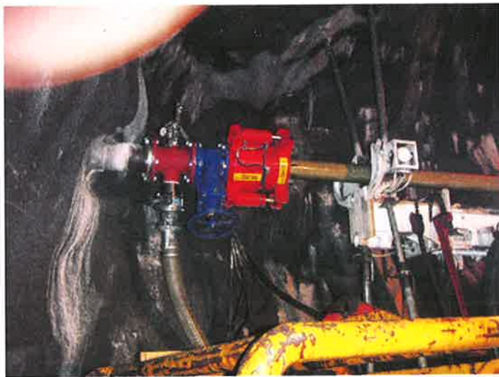
Fig. 7. Drillhole preventer for diameters from 50 to 150 mm and pressures up to 50 bar Bild 7. Bohrlochabsperrepreventer für Bohrdurchmesser von 50 bis 150 mm und Drücke bis zu 50 bar
