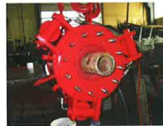
Fig. 7. Drillhole preventer for diameters from 50 to 150 mm and pressures up to 50 bar Bild 7. Bohrlochabsperrepreventer für Bohrdurchmesser von 50 bis 150 mm und Drücke bis zu 50 bar
